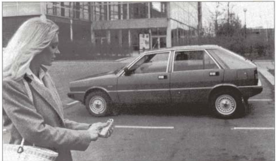
Sur la Lancia revue et corrigée par Motorola, on peut dialoguer avec l'informatique de bord de l'extérieur du véhicule. La preuve, on déverrouille les portières et l'on abaisse les vitres à distance.
