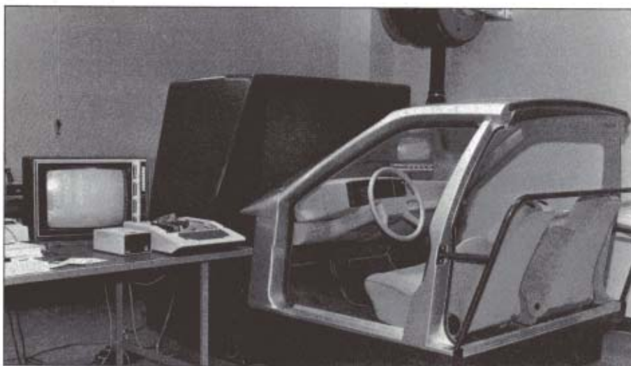
Lors de la mise au point du véhicule Eve, les chercheurs du département scientifique de Renault se sont servis d'un micro-ordinateur Apple pour enregistrer les réactions des conducteurs face à différentes situations routières simulées sur un écran.
