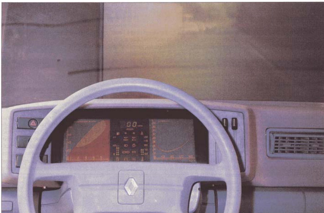
« On sait le faire », Renault donne peu d'informations sur ses recherches. Ce document exceptionnel constitue la preuve que la firme française maîtrise la technologie des écrans couleurs à cristaux liquides (ici dans une cabine de simulateur).
