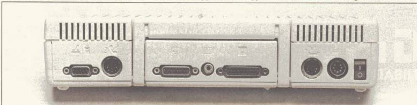
La partie arrière du micro-ordinateur comporte 6 interfaces en standard pour le faire communiquer avec le monde extérieur.
