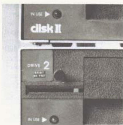
Sur le lecteur 1, le bouton possède deux positions fixes. Sur le second lecteur, l'interrupteur n'est que fugitif afin d'éviter les « surprises ».
