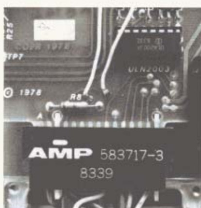
Sur le lecteur « objet », en général le second, vous devez souder un fil sur chacune des deux pistes visibles près de la résistance R8.
